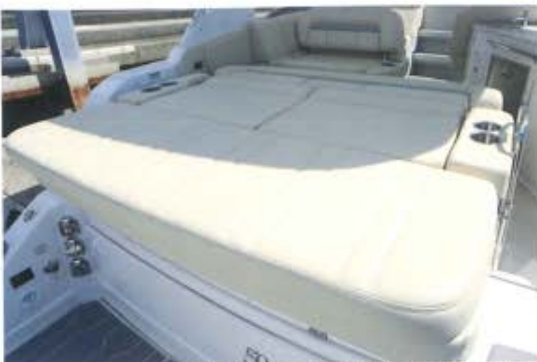
船尾側のシートは前後にスライドでき、また、バックレストを倒す方向や角度にもバリエーションがあるため、さまざまな形態をとることが可能となっています。
