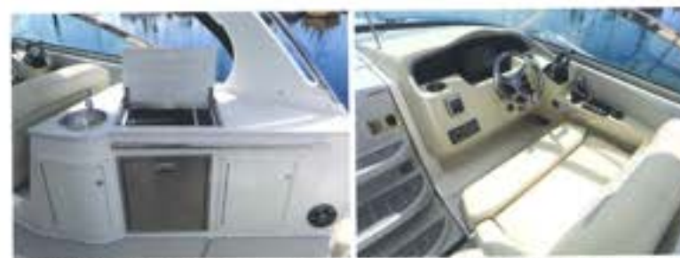
(左) コクピット船尾側右舷には、標準状態でウェットバーが備わりますが、オプションの冷蔵庫やグリルを装備すれば、ちょっとしたエンターテインメントセンターを構築できます。 (右) ヘルムステーションは簡単なグラスコックピット化がなされています。ジョイスティックは汎用のオプティマス360、となりにはハウスマスターのコントローラーが備わります。
