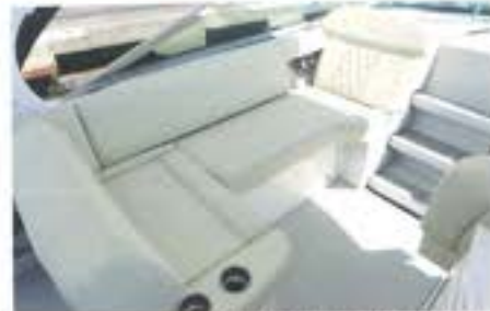
左舷のL形シートは、船尾側端のバックレストを倒す方向によって、通常のL形シートにも、寝椅子プラス船尾向きシートという状態にもできるようになっています。
