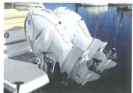
2基のF425は、フルにキックアップするときさすがに大きさを感ぜさせます。ビボット部に電気式ステアリング機構を内蔵しているため、取り付け部分はすっきりとしています
