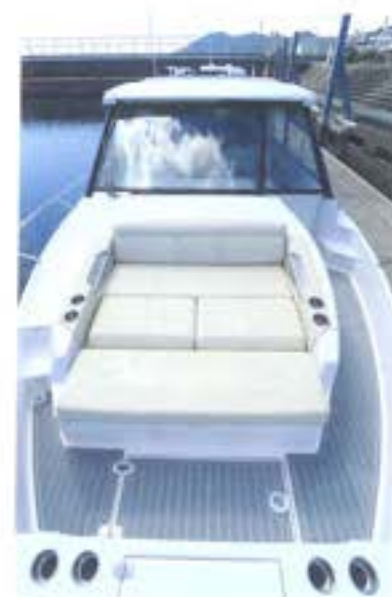
パウエルは左舷側に通路を設けた左右非対称タイプ。米国船ではちょっと流行です。このモデルの場合は、シート部分が大型サンパッドにも、2列シートにもなります
