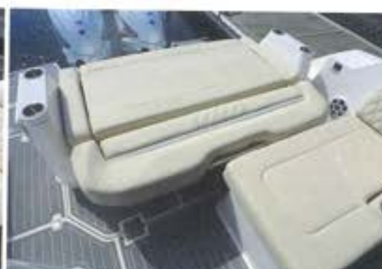
船尾コクピット。トランサムシートはバックレストを倒す方向を変えられますし、前後にスライドもできます。これでサンパッドから対面型ダイネットまで形を変化できます
