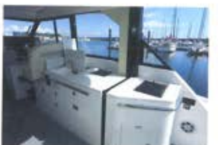
コクピットのグリル部分とハウス内のギャレーとは一直線の配置。スライディングドアのないタイプなら一体化されますが、ドアのあるタイプはその部分のガラスが昇降式です
