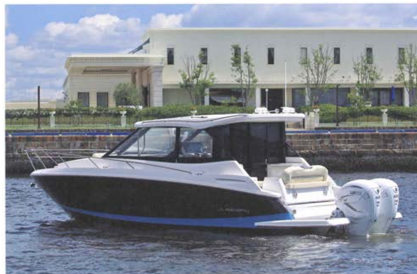
大柄な船外機の2基掛けですが、F425自体がステアリング機構を内蔵していてすっきりとまとまっているため、船外機側ならではの新しい機能美のようなものも感じさせます
