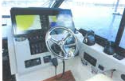
ヘルムステーションはグラスコックピット化がなされており、2基のディスプレイで情報を表示。エンジン関係については、右下のコマンドリンク専用モニターでも表示されます
