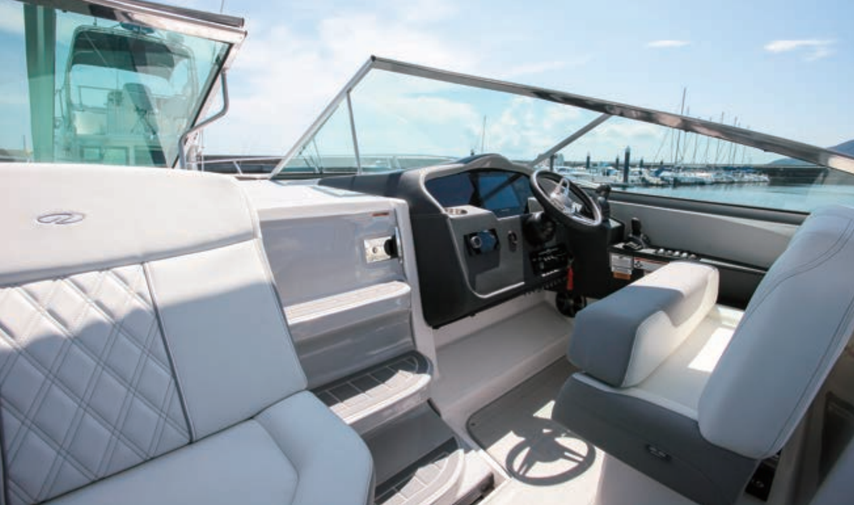
ドライバーズシートはフリップアップ可能で、スタンディングでも操船しやすい。ステアリングホイールもチルト角度を調節できるため、キャプテンの姿勢や好みに応じてアレンジできる。
