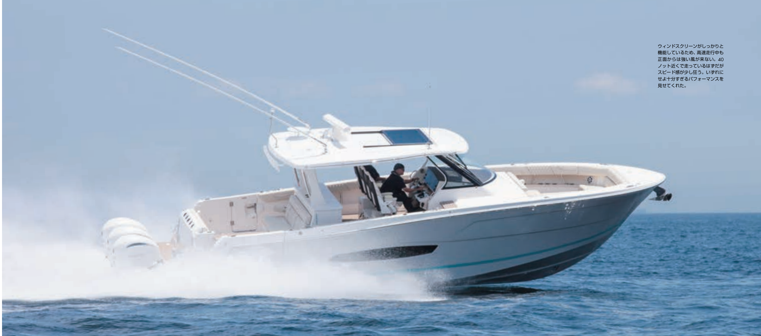
YAMAHA F300F トリプルアウトボードのパワートレイン。静音性も高く、走行中もある程度会話ができるレベルだった。
