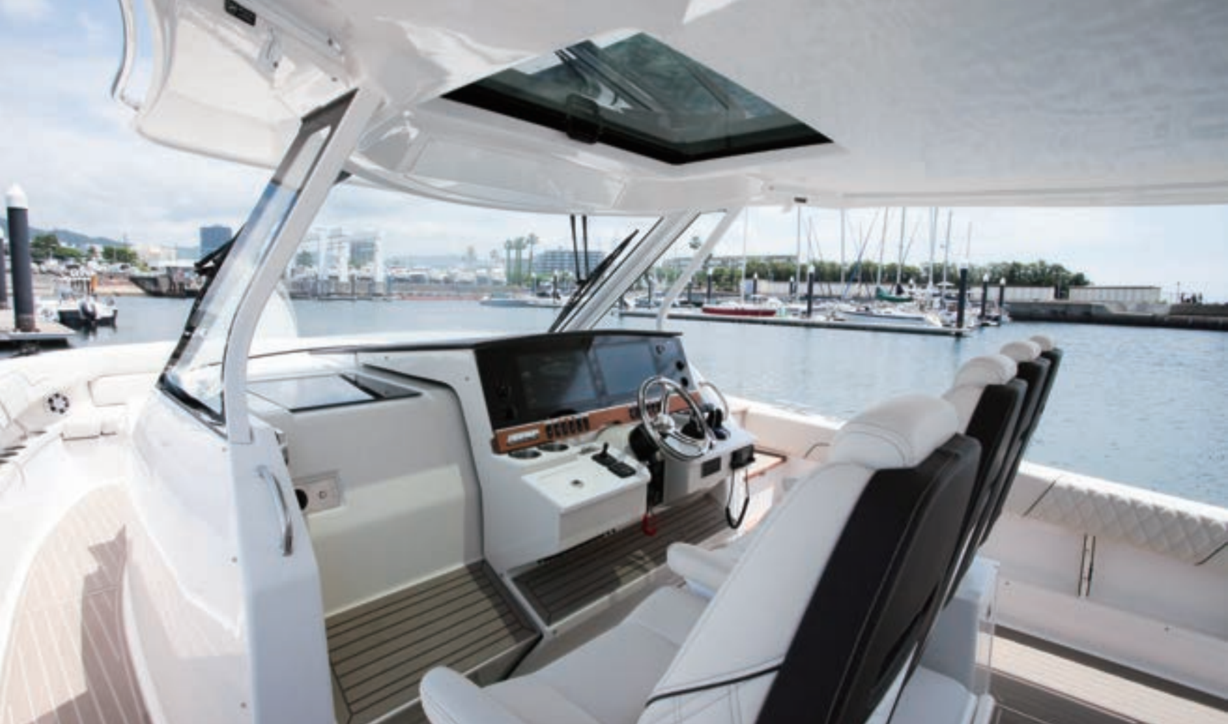
クワッドシートの右から2番目がドライバーズシート。見やすい大型タッチスクリーンを中心に、各種スイッチやコントロール系が並ぶ。ハードトップはサンルーフ付きだ。
