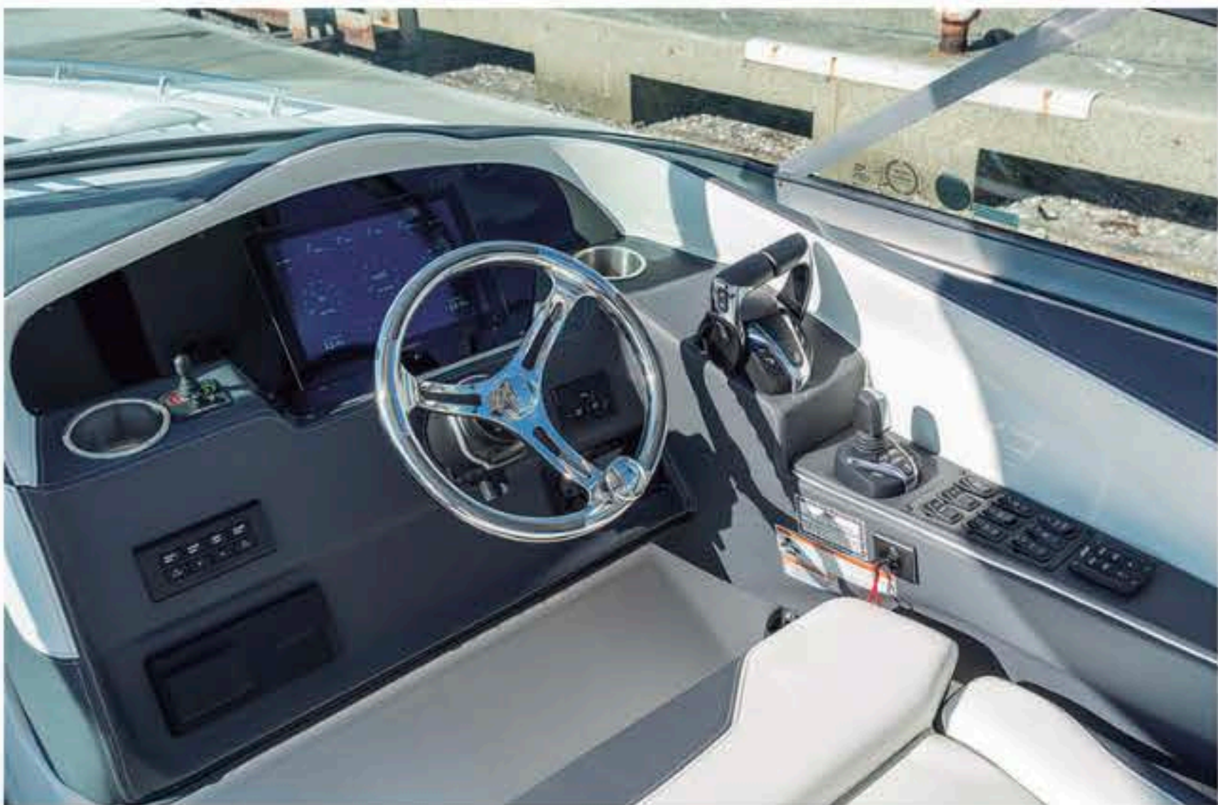
ヘルムステーション。多機能ディスプレイ1基で、エンジン関連のデータ表示から航法、測深までこなしてしまうというのは、いかにも現代のモデルらしいところだ
