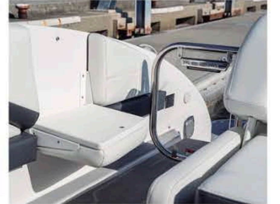
上：船尾、トランサムドアの脇には、ボーディングステップが備わります。簡単な仕掛けの折り畳みステップですが、岸壁の高さによっては、これが必要なこともあるでしょう
