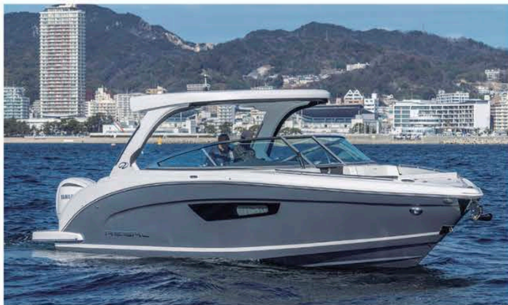
パウライダーは上部構造がシンプルなので重心位置は低めです。静止状態での安定感は、ファミリーユーザーにも使われることが多いこの種のモデルにとって大きなメリットです
