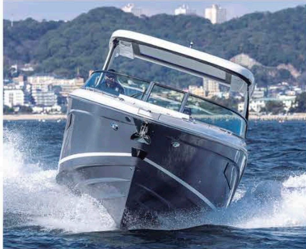
シアーラインは船首下がりのリバースシアーなのですが、航走状態で船首が少し持ち上がると、前方視界が確保されたままで、デッキ面が水平になるという、うまい設計です
